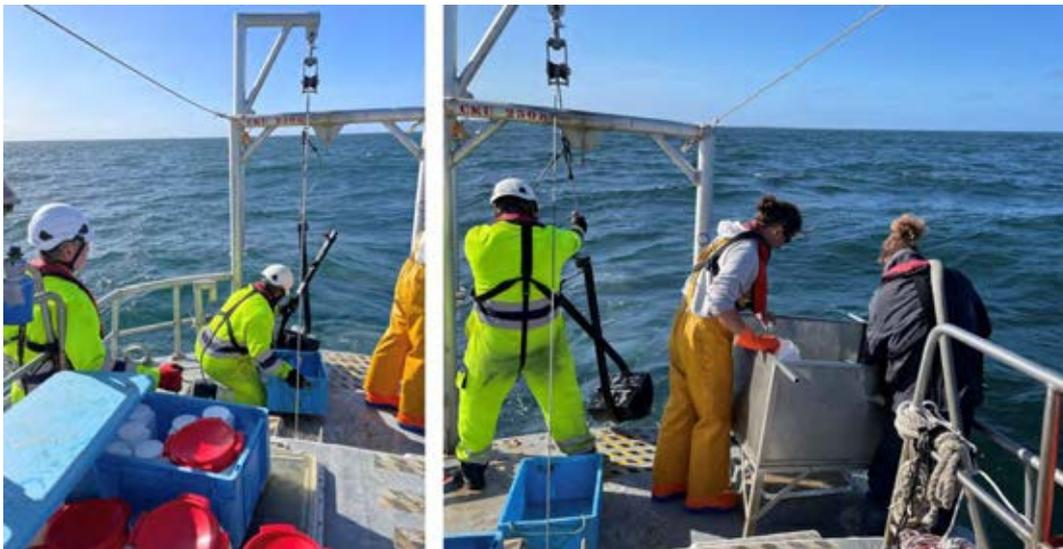
Figure 9. Prélèvement à la benne Van Veen et tamisage
